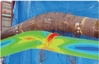
▲ ガスパイプラインの変形挙動解析 FEM simulation for deformation of gas pipeline
