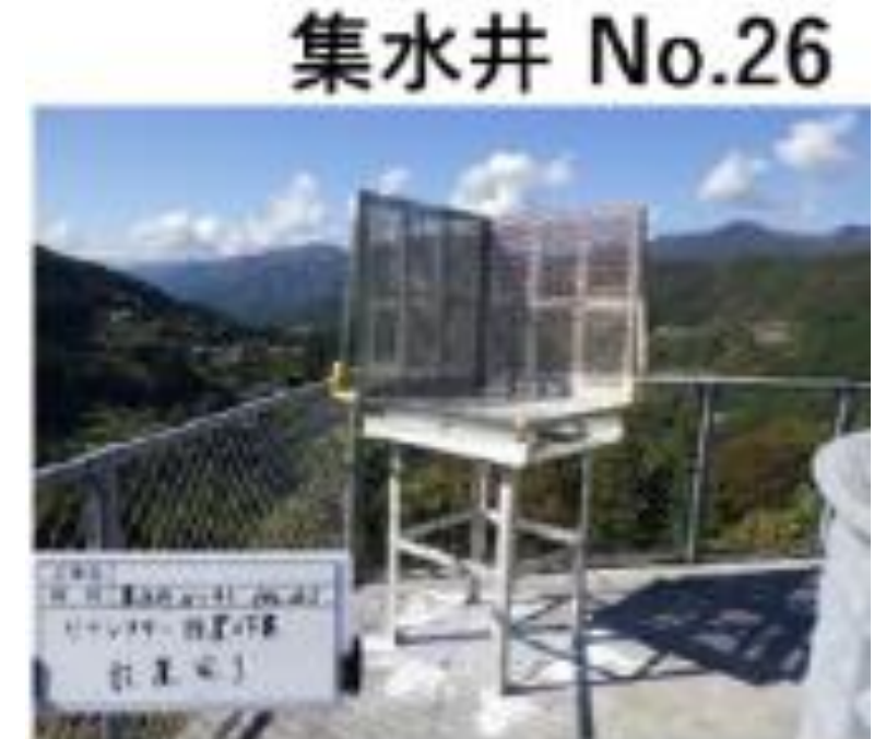
写真4-1 コーナーリフレクター設置状況の例
