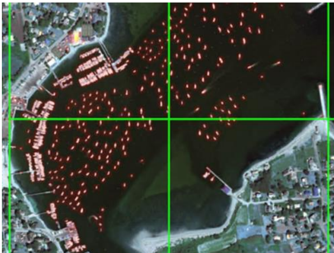
グリッドの中の抽出された対象物(船舶)に対して、ピクセルセグメンテーションを実行したサンプル
