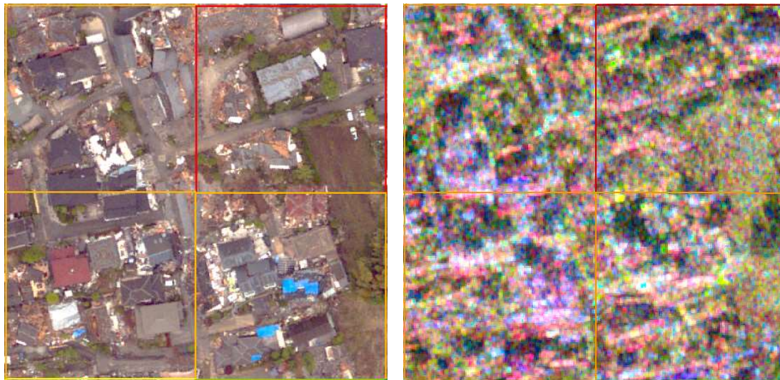
(d) high collapsed ratio area ( R_c \geq 60\% )
